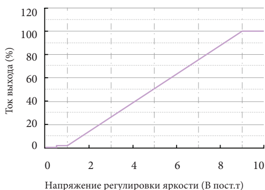
Кривая регулировки яркости 0-10В
