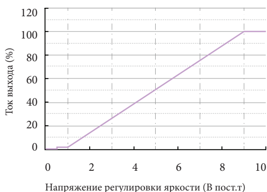
Кривая регулировки яркости 0-10В
